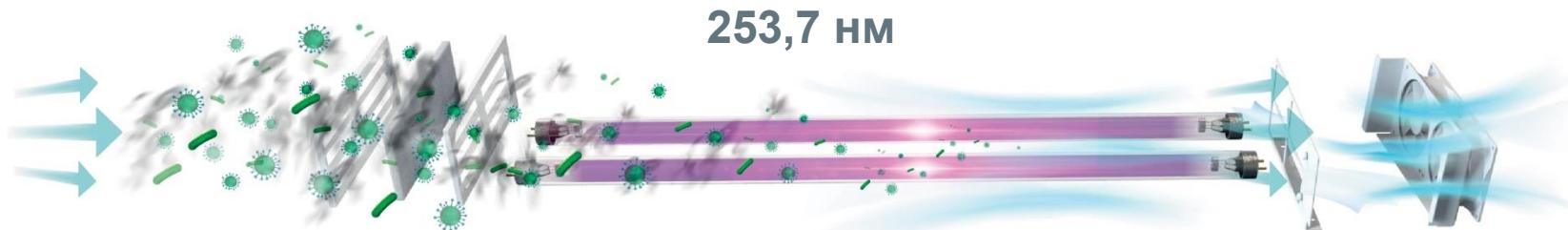
Воздух прогоняется через закрытый корпус со встроенными УФ-лампами с узким спектром 253,7 нм.
